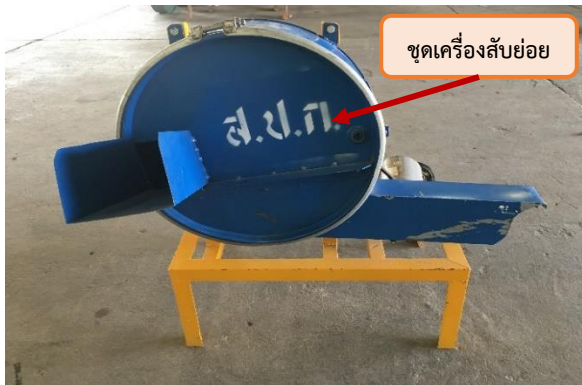
ภาพที่ 1 ส่วนประกอบหลักของเครื่องสับย่อยพืชอาหารสัตว์และวัสดุทางการเกษตร
