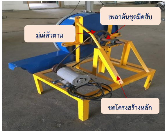
ภาพที่ 9 ระบบการส่งกำลัง เครื่องสับย่อยพืชอาหารสัตว์และวัสดุทางการเกษตร
